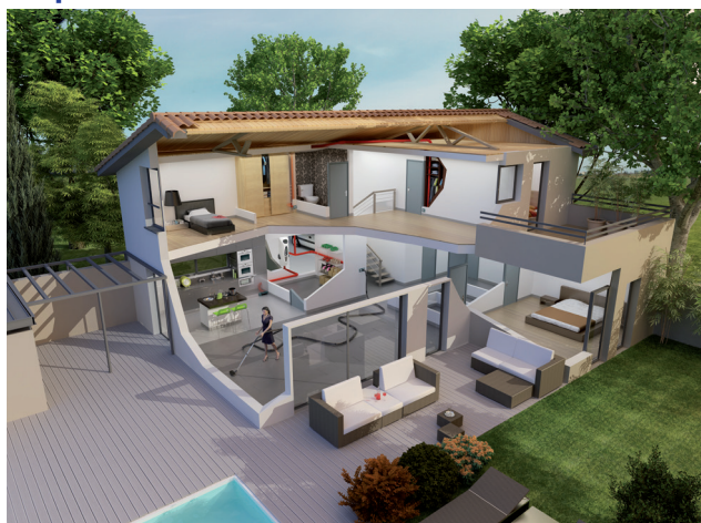
Principio di funzionamento dell'aspirazione centralizzata
