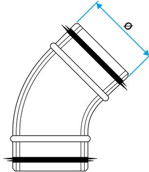
Schema di ingombro Gomito a 45° con guarnizione
