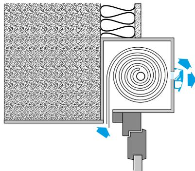
Vue en coupe mise en œuvre entrée d'air EHC
