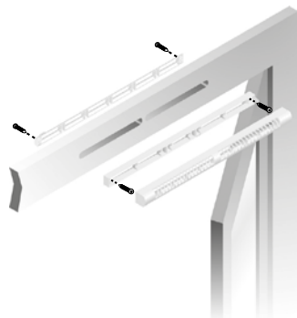
Mise en œuvre entrée d'air EMMA
