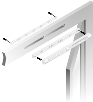
Mise en œuvre entrée d'air EMMA
