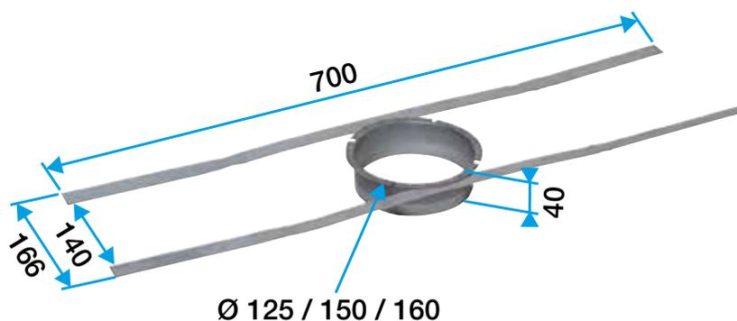
Encombrement fixation pour rejet sur tuile à douille
